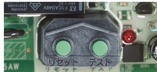
漏電安全装置
