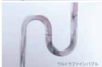
【実験方法】排水管に疑似汚れを溜め、流量7L/分で通水。
