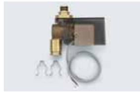
CCHジョイント接続で熱源機下に直接取り付けできる最大流量30L/minの熱動弁。往き配管接続用。
