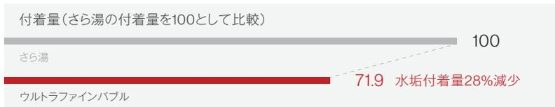
【実験方法】ガラス板に約1L/分の条件で試験水を流水。流水、乾燥各1時間を1サイクルとし、100サイクル経過後のカルシウム付着量を
