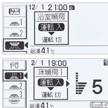
*台所リモコンで床暖房や温水暖房端末を操作する場合があります(初期設定が必要)
